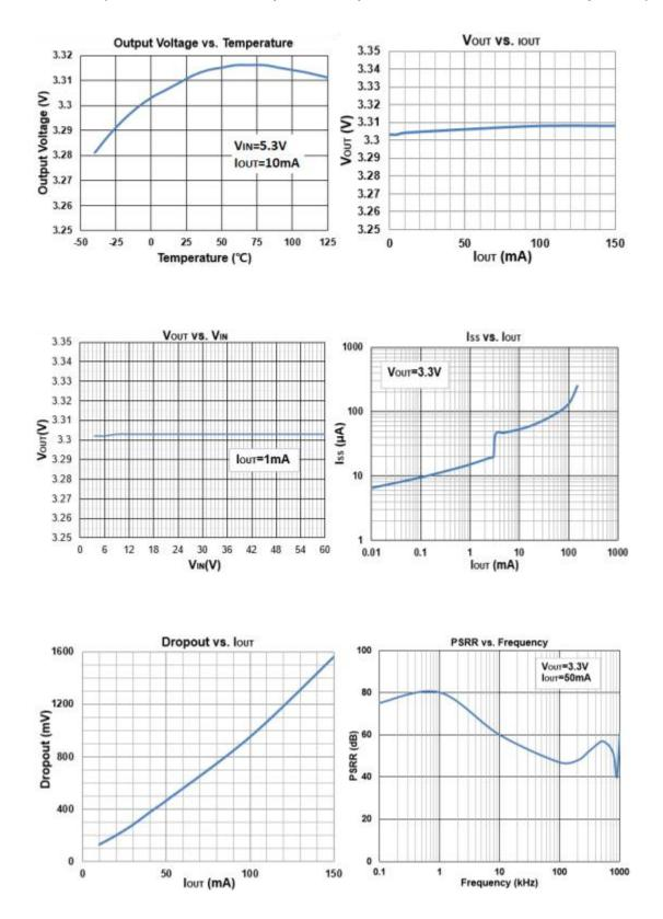
(V<sub>CE</sub>=V<sub>IN</sub>=V<sub>OUT</sub>+2V, C<sub>IN</sub>=1µF, C<sub>OUT</sub>=10µF, T<sub>A</sub>=25℃,unless otherwise specified)
